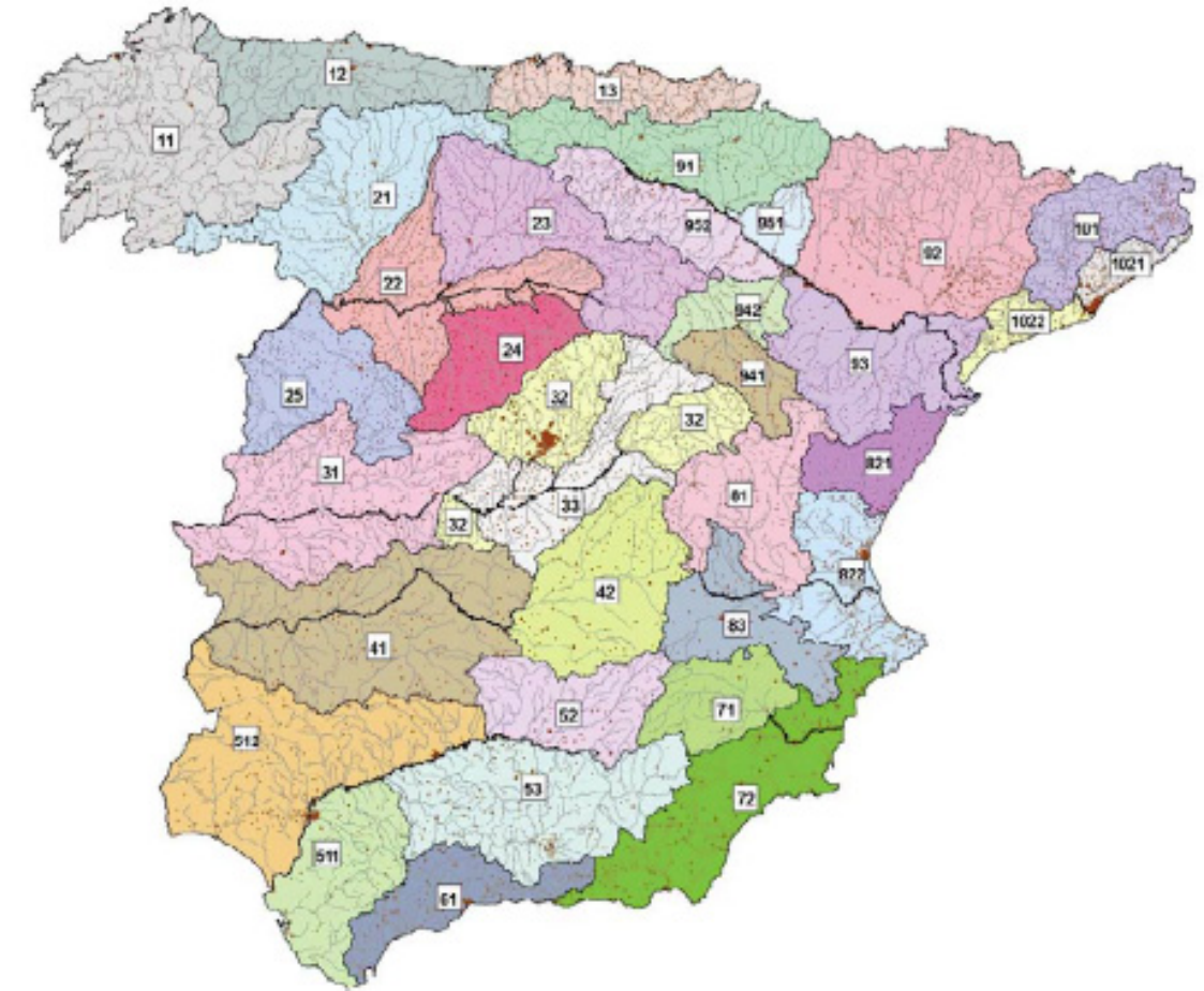
Figura 9. Rexións consideradas para a caracterización do coeficiente corrector do limiar de escorrentía (fig. 2.9 Instrución 5.2-IC).
